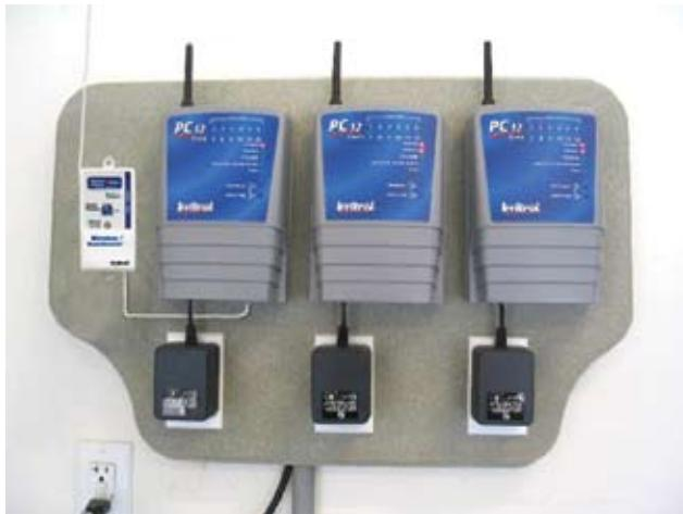
Se ilustra el modelo de 36 estaciones con el sensor de lluvia
